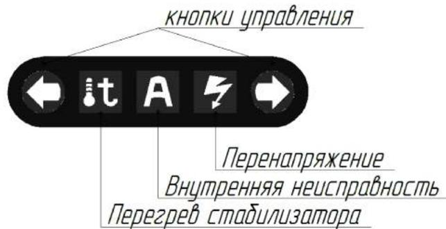
Рисунок 3. Кнопки управления и пиктограммы неисправностей.
